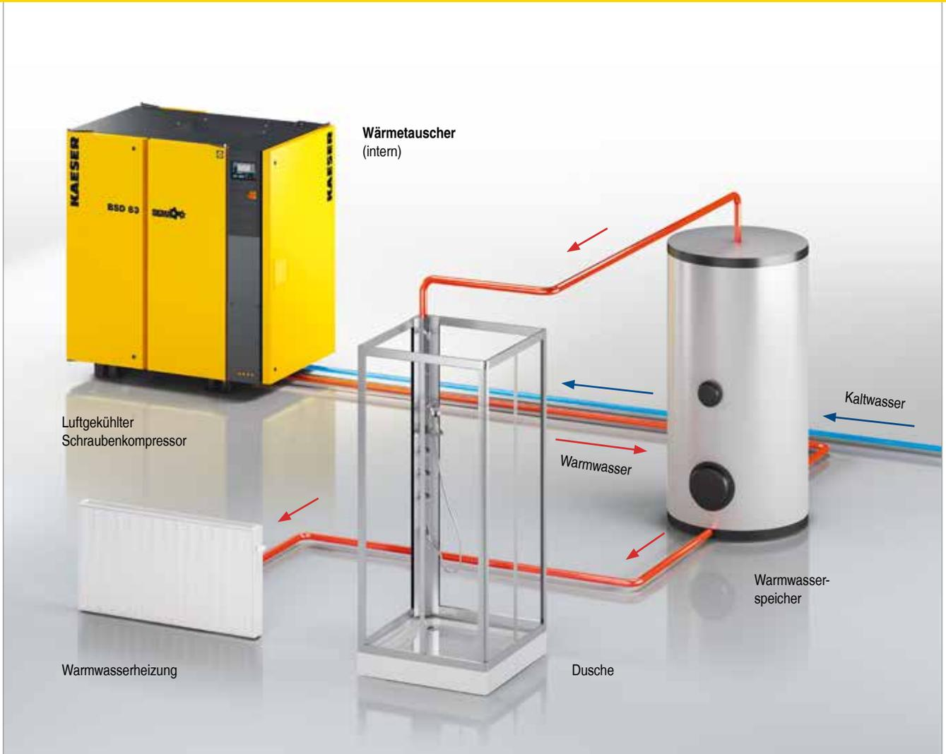
Abb.: Schema Wärmerückgewinnung; Anwendungen für Trinkwasser nur in Verbindung mit speziell abgesicherte Sicherheitswärmetauscher (SWT) möglich
