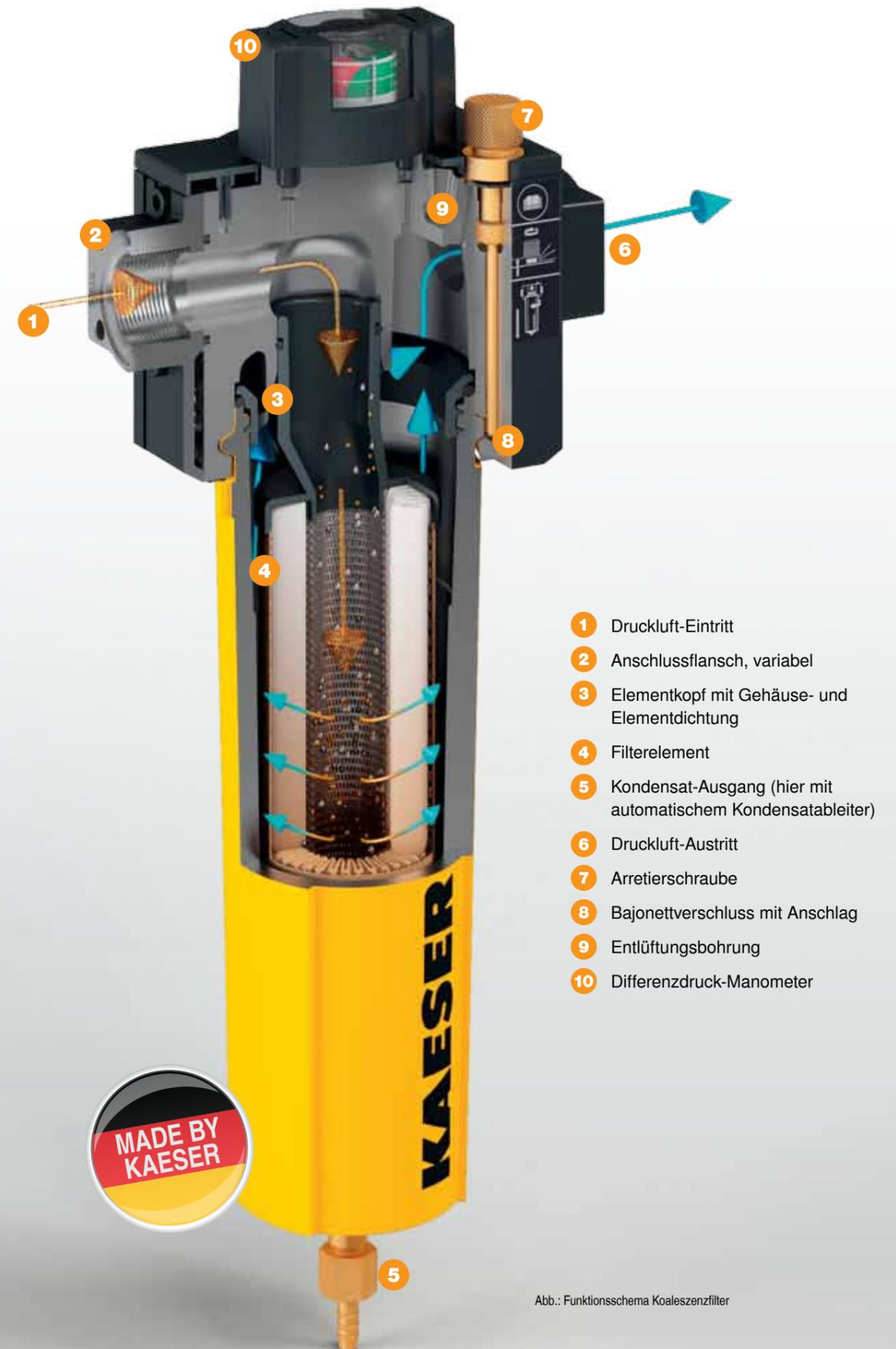
Abb.: Funktionsschema Koaleszenzfilter
