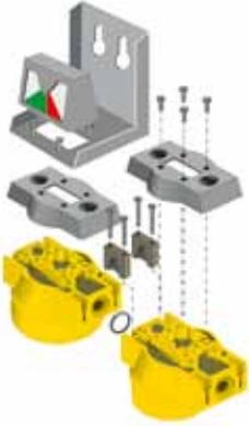
Modulares Verbindungskonzept zum einfachen Anschluss weiterer Filter (z. B. Ausbau zur FFG-Einheit)
